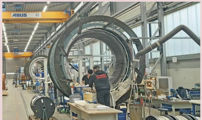
Ein Blick in eine von insgesamt 20 Betriebshallen der Partzsch Unternehmensgruppe. Die Mitarbeiter hier bauen an Statorn für Windkraftgeneratoren. Foto: Maria Fricke
